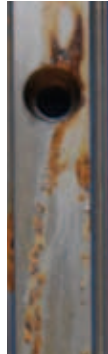
Kolejnice HIREs (bez zatížení) po 32 hodinách zkoušky solnou mlhou (podle DIN EN ISO 9227)
