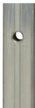
Obr. 3: Kolejnička s povlakem CZS – po 99 hodinách testu solným postřikem (podle normy DIN EN ISO 9227)
